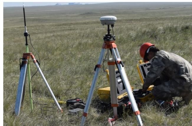
Рисунок 1 – GNSS-оборудование: переносная база в процессе сборки и установки: радиоантенна и приемник Trimble, RTK ровер.
